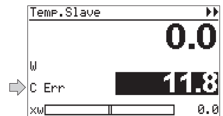
Fig.: 75 Faulty cascade wiring
